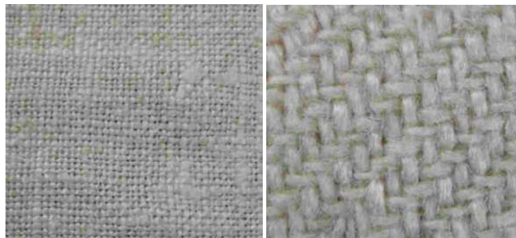
Abb. 9: Leinwandbindung. Bei dieser Webart verlaufen die waagerechten Fäden (Schuss) immer abwechselnd über und unter einem senkrechten Faden (Kette).
